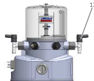
Рис. 26. Замена насосного элемента и клапана ограничения давления
